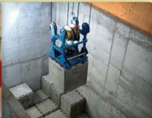
Radioaktiivsete jäätmetega täidetud betoonkonteinerid tõstetakse vahehooldlasse.
