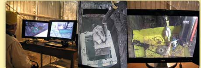
Töötajate ohutuse huvides on kõrgaktiivsete jäätmete eemaldamisel kasutusel raadiojuhitav manipulaatorkraana.
