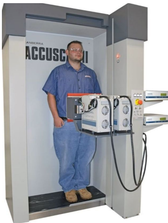
Foto: radioaktiivsete materjalide ja ioniseeriva kiirguse allikatega töötavate töötajate sisekiirituse kontroll
