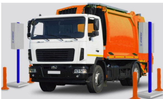
Foto: sõidukite radioloogilist kontrolli peahoone territooriumilt lahkumisel teostab statsionaarne portaalimonitor
