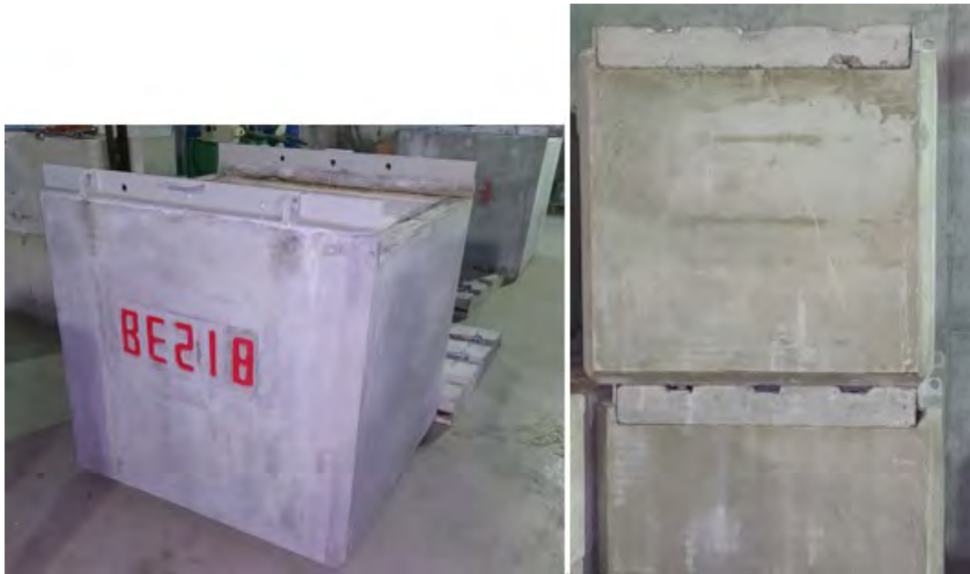
Joonis 2.6. Betoneeritud jäätmeid sisaldavad standardsed betoonkonteinerid on kõige levinum konteineri tüüp
