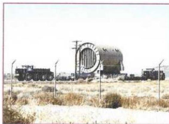
Reaktorisektsioonide transportimine vaheladustuspaika (USA)
