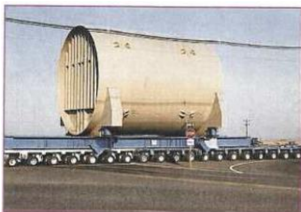
Reaktorisektsioonide transportimine vaheladustuspaika (USA)
