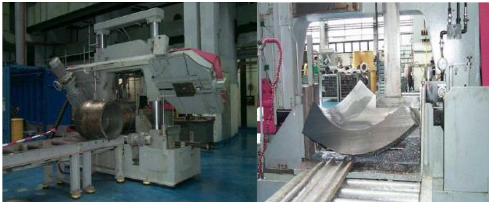
Näited dekomisjoneerimiseks kasutatavate tööpinkide kohta (Behringeri horisontaalne lintsaag)
