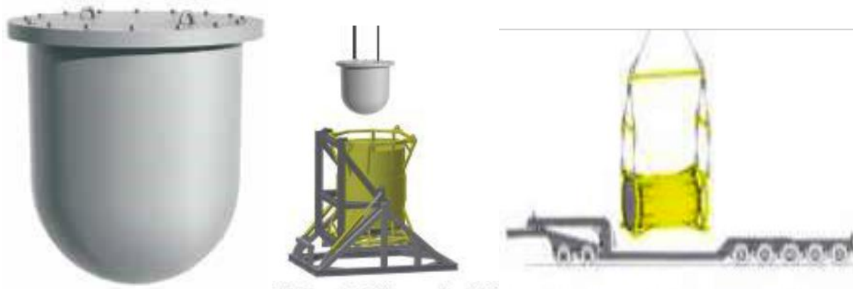
Reaktorisektsiooni paigutamine transpordikonteinerisse (Suurbritannia)
