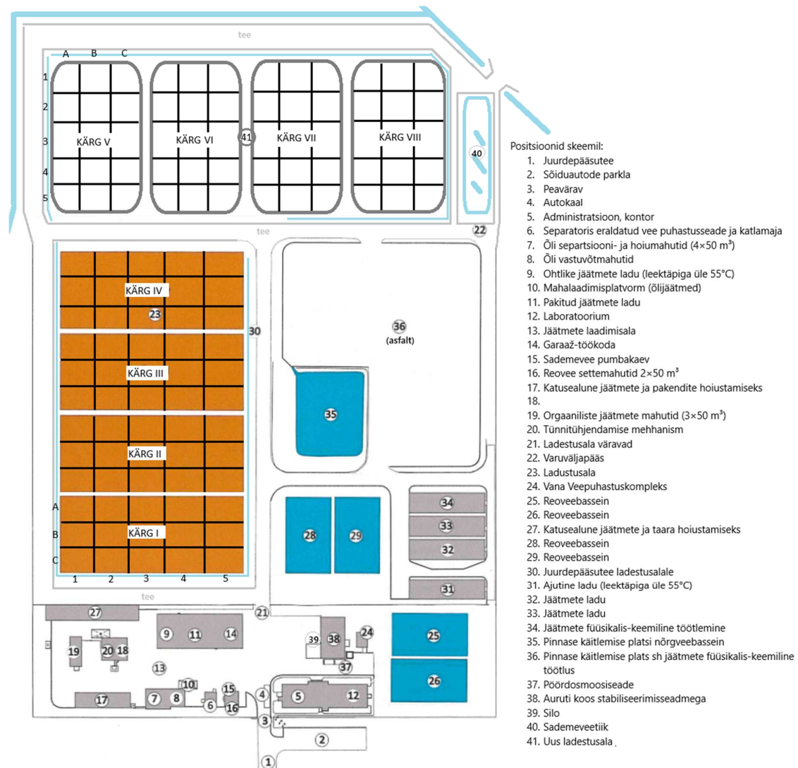
Joonis 0 Vaivara Ohtlike Jäätmete Käitluskeskuse skeem.
